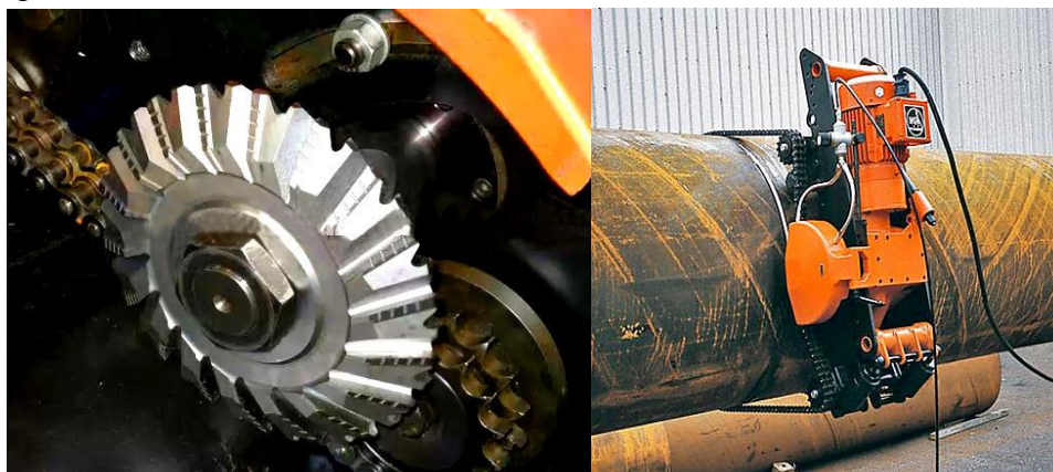
Рисунок 5: а- исходная фреза, установленная на оправке; б- трубофрезерная машина.
