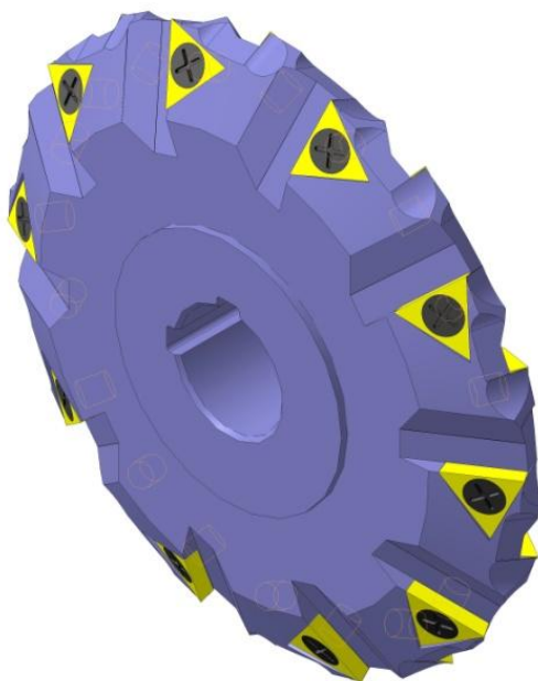
Рисунок 3- Фреза с тангенциальным расположением пластин
