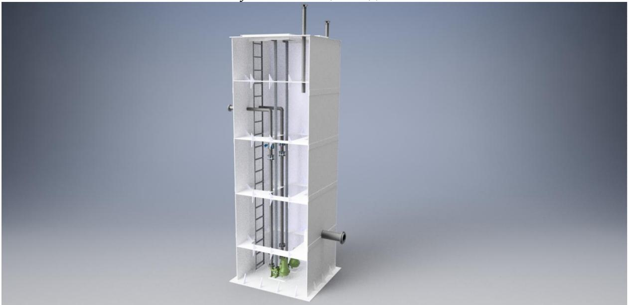
Рисунок 2 – Конструкция КНС
