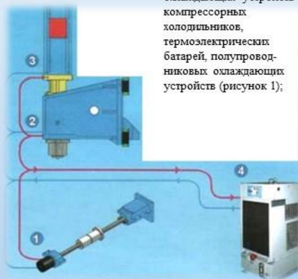
Рисунок 1 – Схема охлаждения опор шпинделя и передачи винт-гайка
