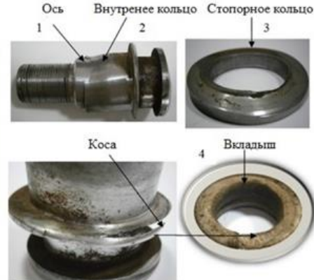
Рисунок 1 – Элементы узла трения сошника сеялки после эксплуатации:
