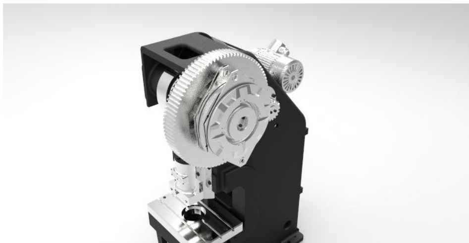
Рисунок 6 - Сборочная 3D-модель прессы однокривошипного K2130B, визуализированная в программе KeyShot 6
