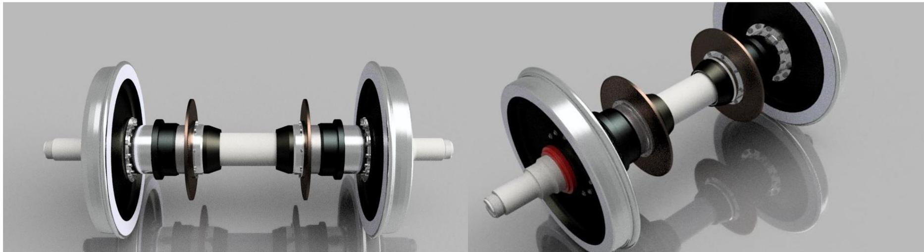
Рисунок 1 – 3D модель раздвижной колесной пары
