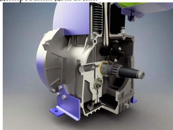
Рисунок 5 – Моделирование масляной системы двигателя
