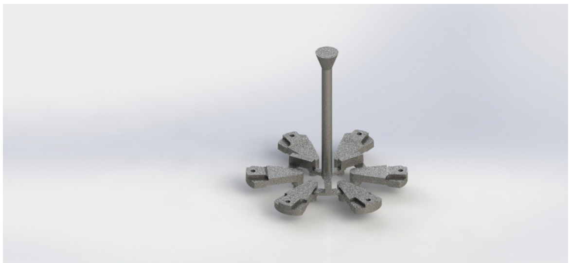
Рисунок 7 – Сборочная модель”отливок “ Рычаг” с литниково-питающей системой
