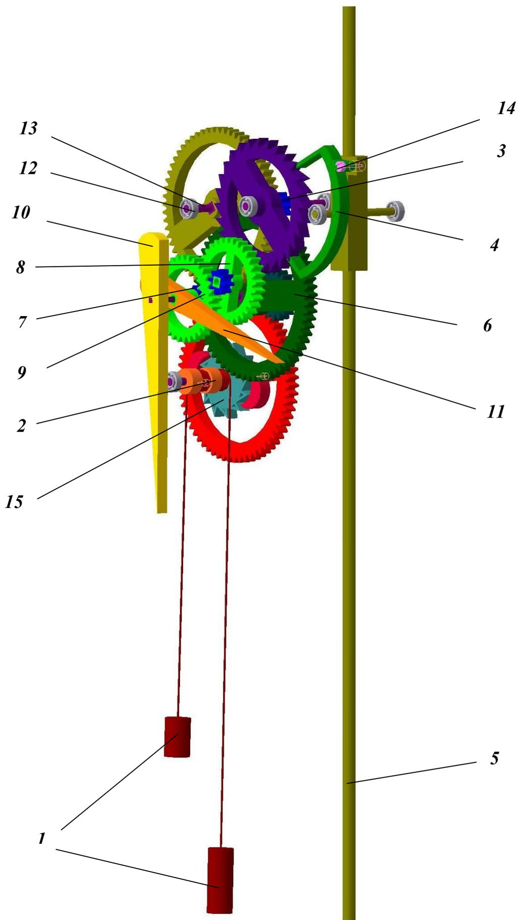
Рисунок 1 – Устройство маятниковых часов
