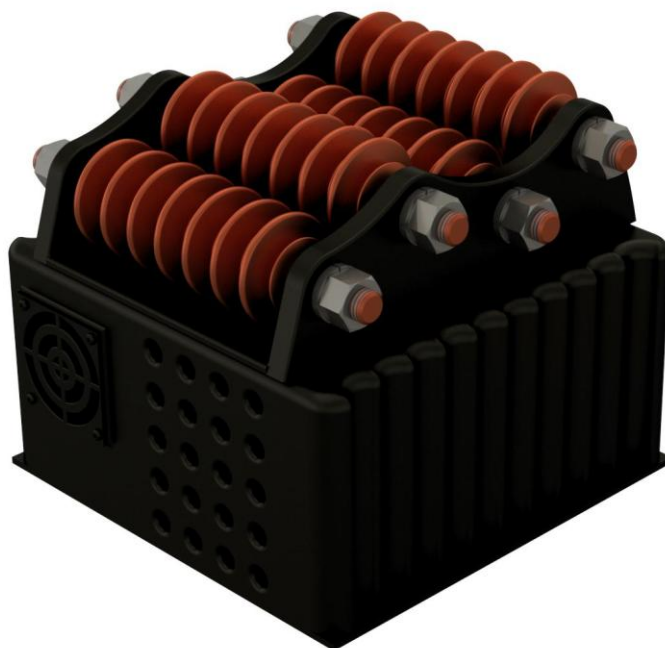
Рисунок 7 – Тяговый инвертор и тормозные резисторы
