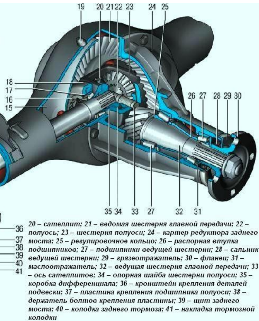
Рисунок 1.- Ведущий мост автомобиля ВАЗ-2101
