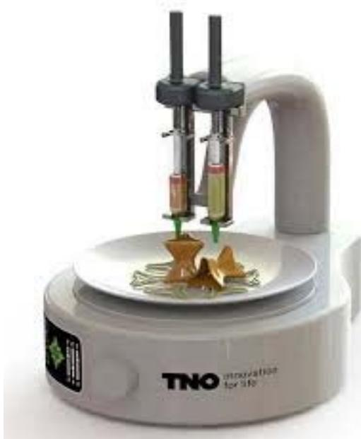
При разработке ставилась цель скрыть рабочие элементы 3D-принтера. Разрабатываемая модель 3D-принтера должна быть удобной в использовании, простой, точной и иметь малые габариты. Последний критерий достигался тем, что печатающий элемент не только был скрыт, но и имел телескопический эффект. Рабочие органы разрабатываемого 3D-принтера способны вращаться в любом направлении.
