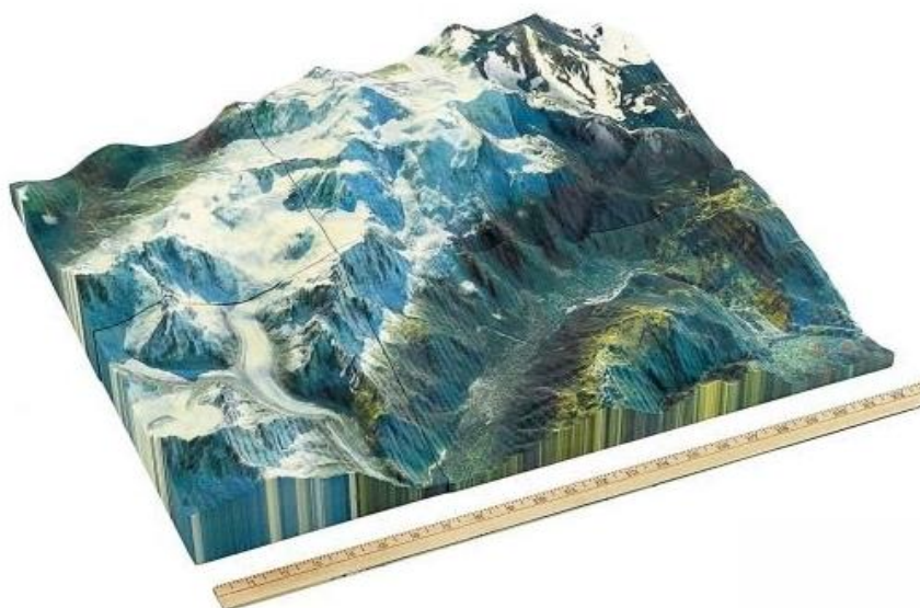
Рисунок 1. Модель местности, созданная с помощью послойного наращивания на 3D-принтере.
